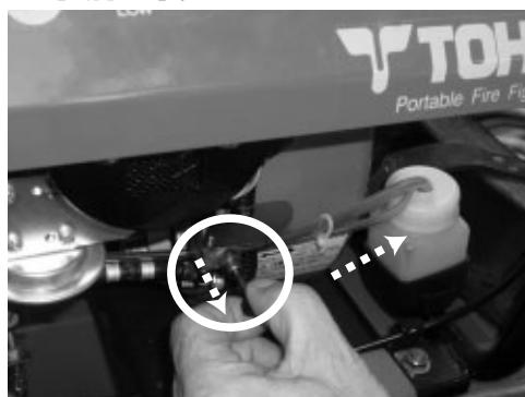
3. 右側の容器に入った燃料を燃料タンクに戻して完了です。
